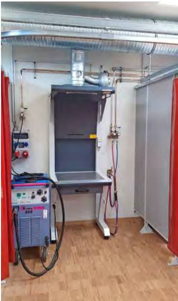
Die Schweiß- und Schleifarbeitsplätze haben neue Absaugungen.
