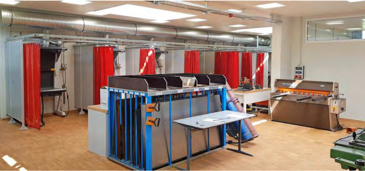
Im sanierten Werkstattraum des Berufsschulzentrums in Schramberg wurde Industrieparkett verlegt. FOTO: WOLFGANG RUOFF/LANDKREIS ROTTWEIL
